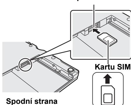
Slot pro kartu SIM je umístěn v příhrádce pro baterii na spodní straně počítače. Chcete-li vložit kartu SIM, odstraňte bateriový blok.
