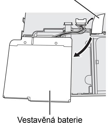
7. Odpojte konektor a vyjměte vestavěnou baterii. (Illustration: modely bez slotu pro kartu Smart Card)
